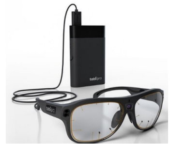
図1. 親子遊び中の親の視線計測装置 見ている場所が赤い丸で表示される
